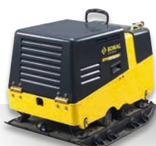
BPH 80/65 S Poids en charge: 750 kg Force centrifuge: 80 kN Largeur utile: 800 mm
