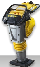
BT 65 Poids en charge: 68 kg Force centrifuge: 17 kN Largeur utile: 280 mm
