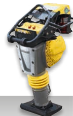
BT 65 G Poids en charge: 75 kg Force centrifuge: 17 kN Largeur utile: 280 mm disponible en DE
