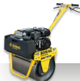
BW 55 E Betriebsgewicht: 150 kg Zentrifugalkraft: 10 kN Arbeitsbreite: 560 mm
