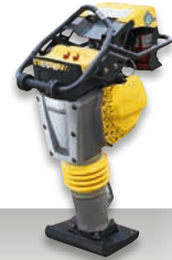
BT 65 G Betriebsgewicht: 75 kg Zentrifugalkraft: 17 kN Arbeitsbreite: 280 mm lieferbar in DE
